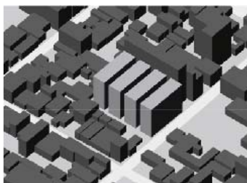
C案 大きなかたまりを細かく分ける 6階+6階+6階+6階 容積率260%
